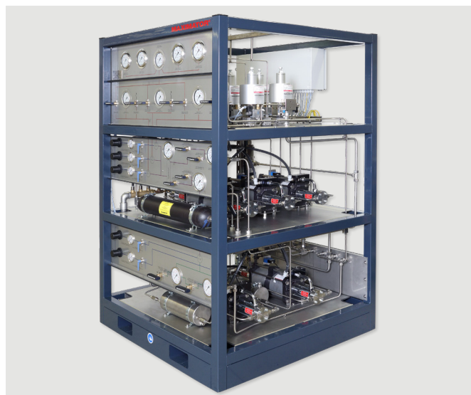
高圧蓄圧器とガス冷却機構を備えたフレームデザインのPLC制御ガスブースターステーション
