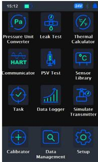
オンボードアプリケーションは、高スタティック差圧モード、圧力リークテスト、安全弁テスト、アナログトランスミッターキャリブレーション、ユニットコンバーター、熱計算機、スナップショットなどの便利な機能を提供します。
