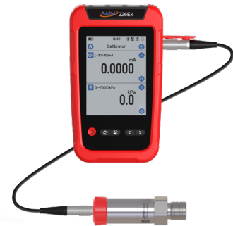
Additel 226Ex と ADT161Ex 圧力モジュールの組み合わせ
