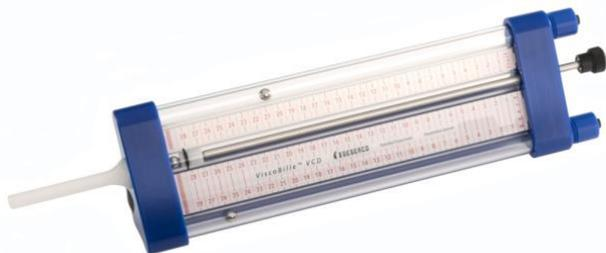
GESERCO Viscobille™ VCD は、試験される液体の粘度を 2 種類の参照液体の粘度と相互比較する高感度かつ正確なツールで、例えば試験液体の最小および最大許容粘度を参照液体として使用します。
