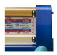
ViscoBille™ V3T と ViscoBille™ V2T の測定 スケールは、4 つの結果 を直接的かつ短時間に 読み取ることができま す。:
