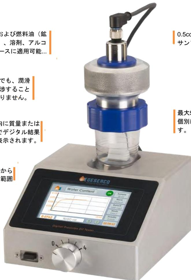
小型で堅牢なDPOT™は、化学の専門知識がないオペレーターが操作した場合でも、非常にシンプルですばやく使用できます。製品のユーザーインターフェースは、ステップバイステップの操作手順を提供し、その豊富な内蔵機能により、使いやすくなっています。
