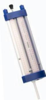
このテストでは、モデル VCD3T 落下球粘度計を使用して、ディーゼル オイルの粘度を、キットに含まれている EN590 に準拠した最小および最大許容粘度の参照標準と即座に比較できます。
